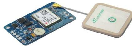
Fig. 1. U-Blox Neo-6M GPS module [5]
